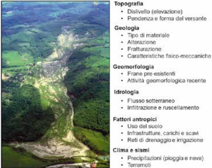
Figura 3 - Principali fattori che controllano la stabilità di un versante
