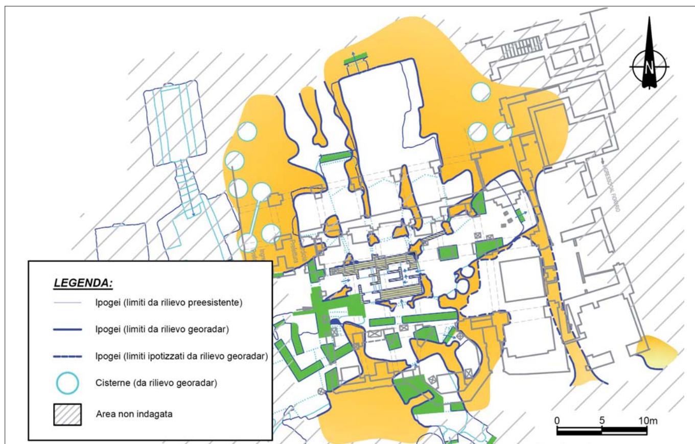
Figura 12 – Planimetria del modello geometrico definitivo degli ipogei e dell'edificio chiesa San Domenico e Prefettura con ubicazione delle nuove cisterne e cavità individuate.
