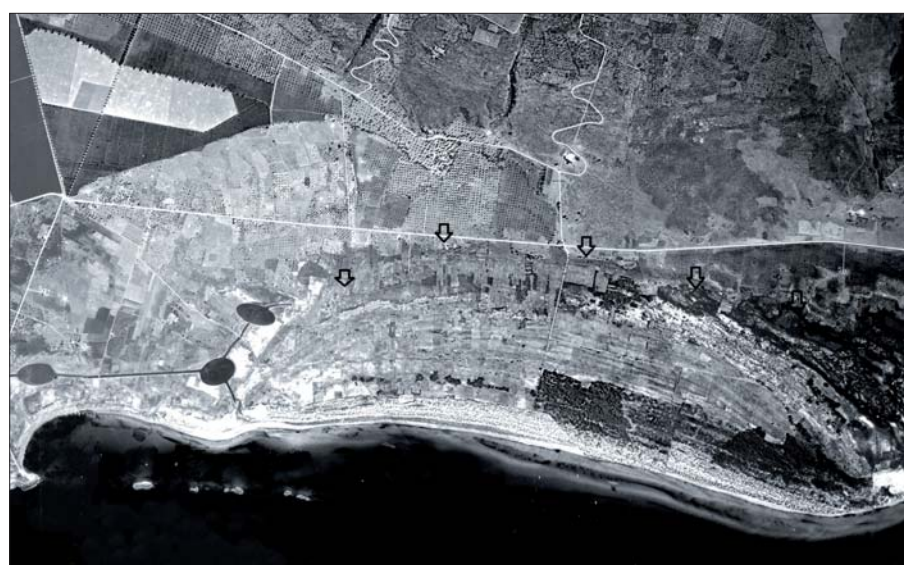
Figura 5 – L'area di Torre S. Giovanni, in alto, in un mosaico di foto aeree I.G.M. del 1943: le frecce indicano le tracce di umidità residua e la laguna costiera oggi scomparsa ma riconoscibile nella stratificazione dei depositi dunari
