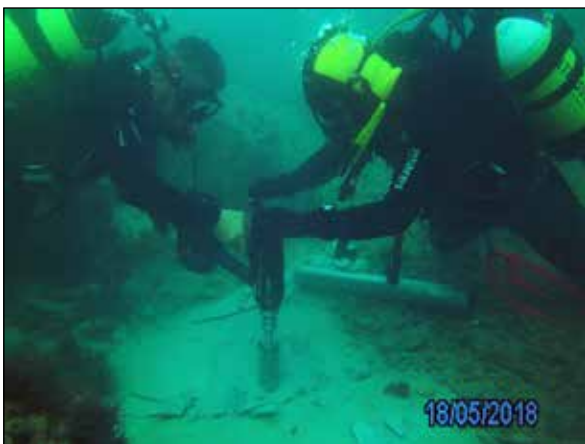
Fig. 9 - Il prelievo del campione per mezzo del trapano "Rodon 100" (foto M. Ponte).
