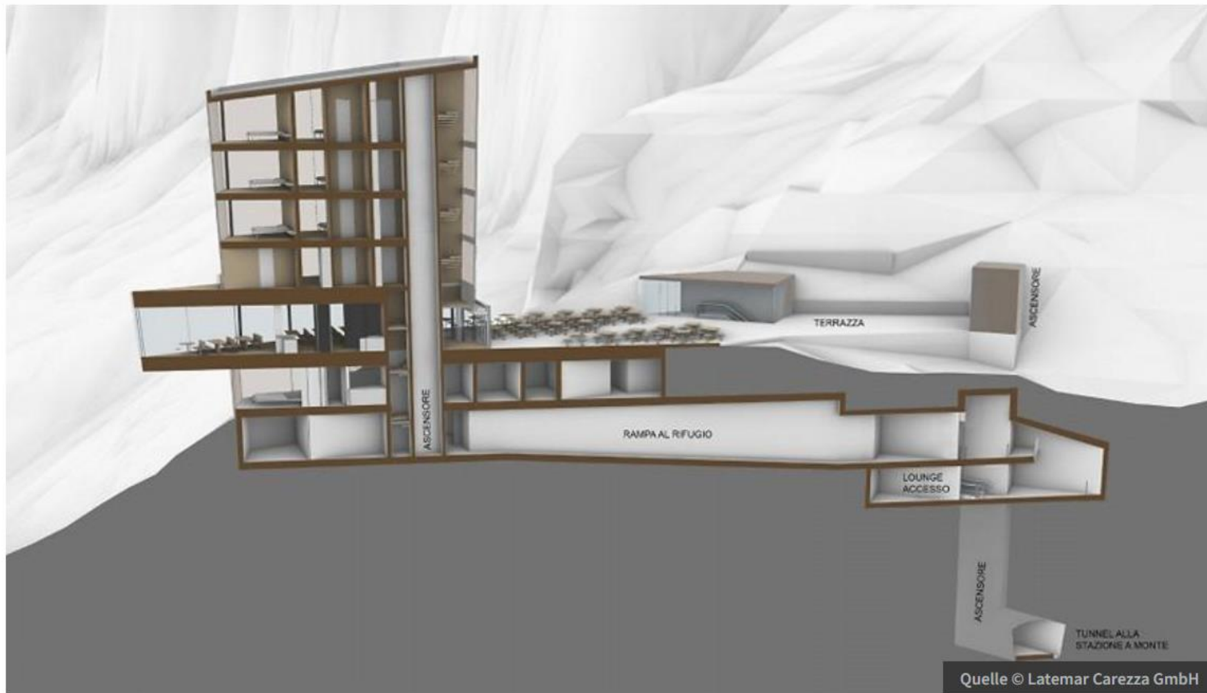
Schnitt mit Glasbau für die Kölner Hütte
