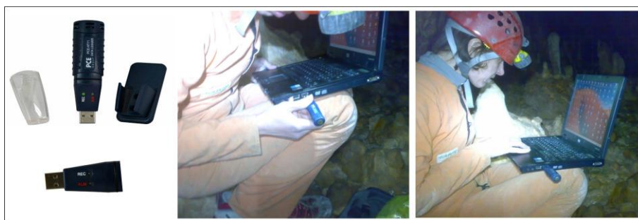
Fig. 5 - Particolare del termoigrometro installato nella grotta degli Arnolfi (PCE-HT71 data logger). Dimensioni 101,5 x 30 mm, Peso 25 g. Campo di misurazione: 0-100% U.r., -40/+70 °C. Risoluzione: 0,1 % U.r., 0,1 °C.
