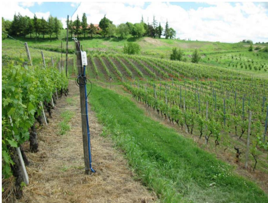
Fig. 5 – La stazione di monitoraggio meteo-idrologico installata presso l'azienda vitivinicola di Cascina Gilli di Castelnuovo Don Bosco (AT). In primo piano la centralina per la registrazione dell'umidità del terreno a diverse profondità; sullo sfondo la centralina meteorologica.
