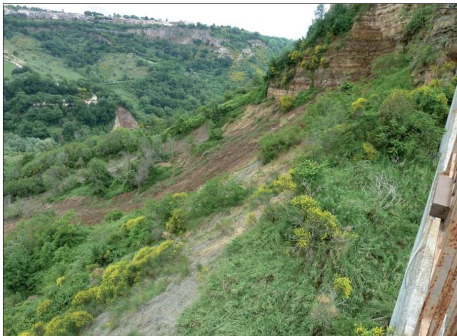
Figura 3 – Una recente frana di crollo che investe la piastra rigida vulcanica lungo il bordo settentrionale del colle di Civita; alla base del versante è l'incisione valliva del Fosso Lubriano. Sullo sfondo l'abitato di Lubriano, sul versante sinistro dell'omonimo Fosso (Foto Gisotti, del 24.05.2015)
