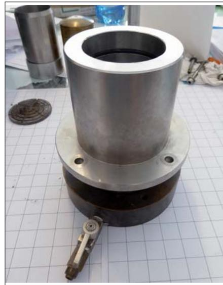
Figura 11 – Cella per estrazione di fluidi interstiziali ad elevata pressione (fino a 200 Bar). (Laboratorio Idrogeologia Applicata, UniBas)
