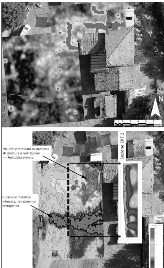
fig. 6 – Area 4000. In alto a sinistra la mappa della magnetometria; in basso la slice del rilievo radar per la resistività.
