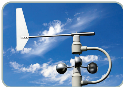
Fig. 42 – la struttura di un anemometro.
