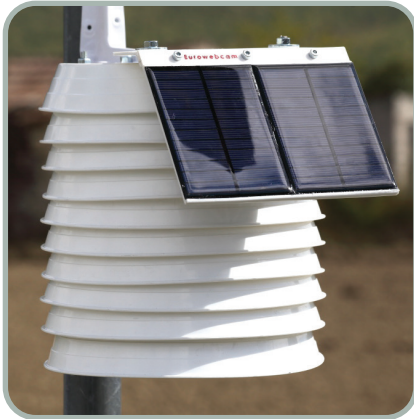
Fig. 35 – sensore termoigrometrico regolarmente allocato all'interno di uno schermo solare.
