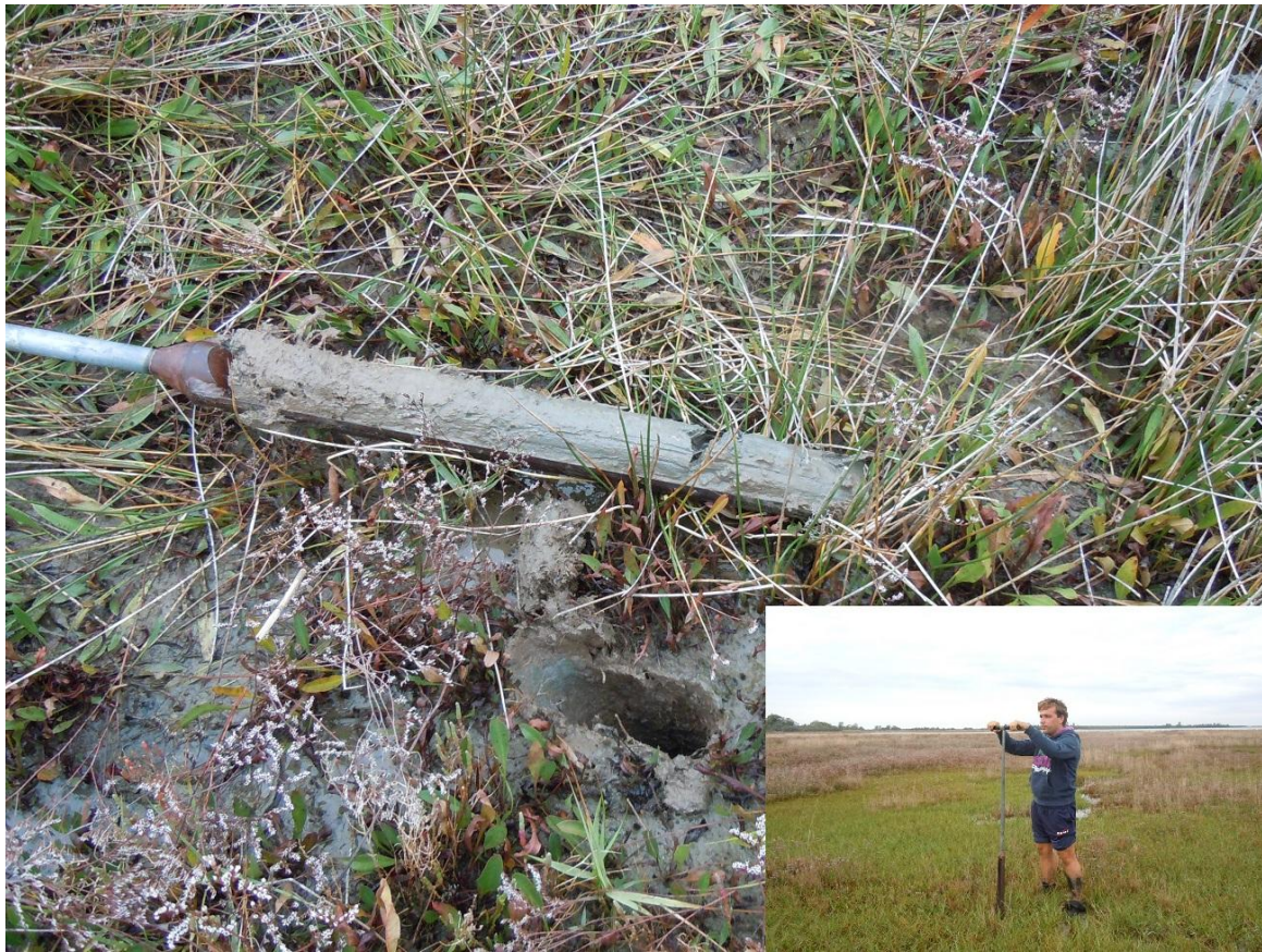
Figura 3.4 - Operazioni di campionamento con la sgorbia.
