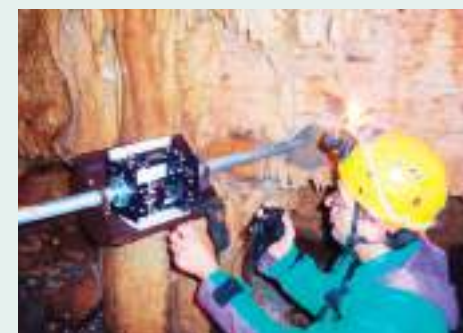
Stazione di monitoraggio dei movimenti tettonici nella Grotta di Nove Casedde
