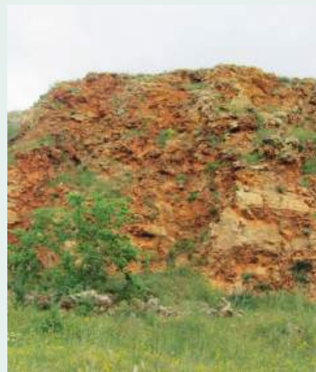
Calcari fratturati, intensamente alterati per carsismo. Il fronte di cava ha una altezza di circa 6-7 m
