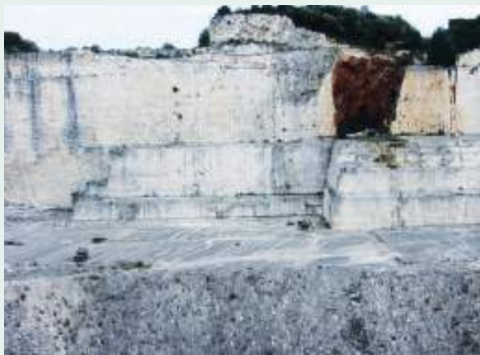
Fronte di cava. Un inghiottitoio riempito da terra rossa interrompe la continuità degli strati calcarei
