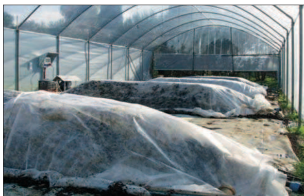
Figura 1 - Impianto di compostaggio "On Farm" con cumuli statici ad insufflazione di aria.
