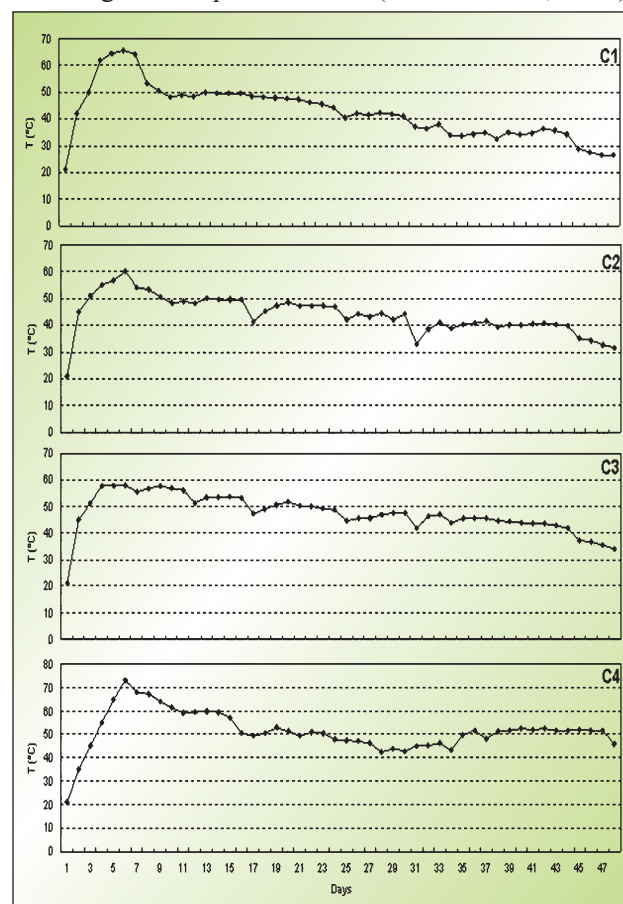
Figura 2 - Andamento delle temperature nei 4 cumuli durante il processo di compostaggio.
